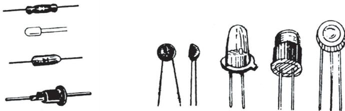
图 1.7 常用二极管的外形结构图
