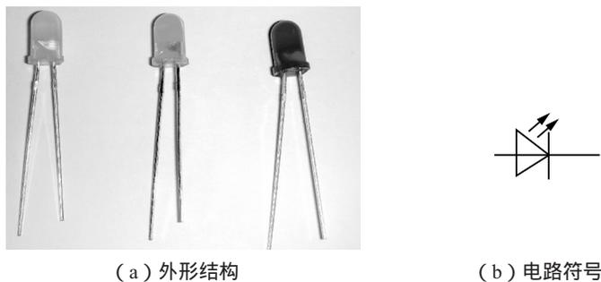
图 1.15 发光二极管的外形结构和电路符号
